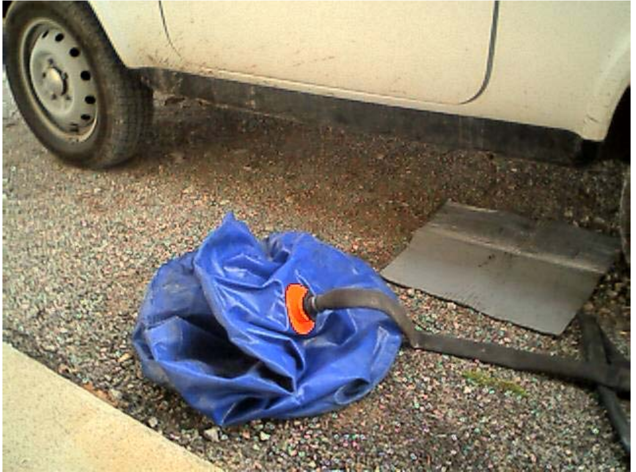
5) Il faut que le moteur tourne, là on voit le tuyau-raccord pour le gonflage.
