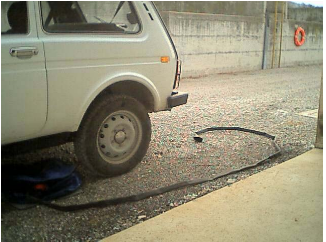
6) Le cric placé sous la voiture, le raccord en place, le cric se déploie.
